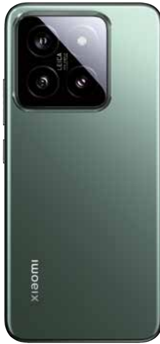
Die Dreifach-Kamera des Xiaomi 14 deckt einen Brennweitenbereich von 14 mm bis 75 mm (KB) ab.
