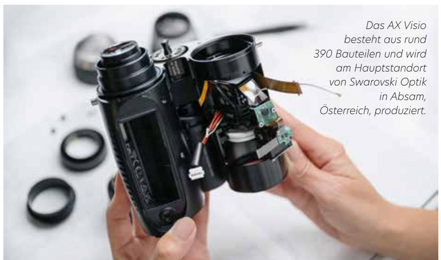
*Das AX Visio besteht aus rund 390 Bauteilen und wird am Hauptstandort von Swarovski Optik in Absam, Österreich, produziert.*
