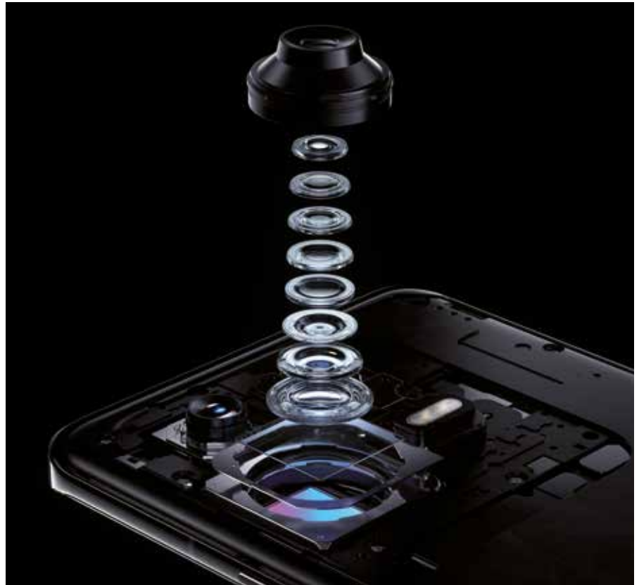
Das von Leica entwickelte 23mm f/1.9 Leica Objektiv des Xiaomi 13 Pro enthält acht asphärische Linsen.
