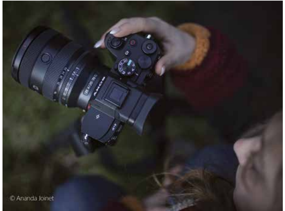
Das FE 20-70 mm F4 G von Sony ist bei einem Durchmesser von 79 mm (Filtergewinde 72 mm) 99 mm lang und wiegt 488 g. Foto: Ananda Joinet
