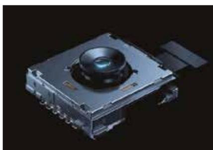
*Der neue Fünf-Achsen-Bildstabilisator (OIS) soll im Vergleich zu herkömmlichen Technologien 65 Prozent mehr Leistung bringen.*
