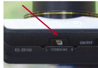
Die Highspeed-Aufnahme wird bei der Exilim EX-ZR100 über einen separaten Knopf auf der Kameraoberseite aktiviert. Auf dem Display wird die gewählte Einstellung durch das Wort „Schnellsérie“ angezeigt.
