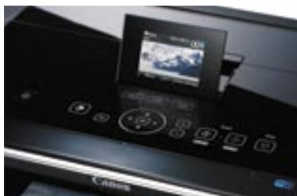
Die neuen Flaggschiffe Pixma MG6150 und MG8150 werden über ein berührungsempfindliches Panel bedient.
