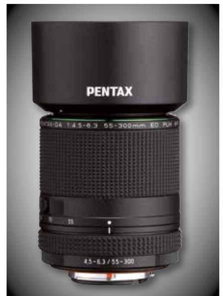
Ebenfalls neu bei Ricoh Imaging ist das Tele-Zoom D Pentax-DA 55-300 mm F4,5~6,3 ED PLM WR RE mit dem KAF4-Anschluss. Es bietet erstmals eine elektromagnetische Blendensteuerung und eine Fokussiermechanik mit Impulsmotor für schnellere und leisere Blendenkontrolle und Scharfstellung. Auch die Videofunktion mit neuem Hybrid-AF der Pentax K-70 wird unterstützt. Das Objektiv soll 449 Euro (UVP) kosten.
