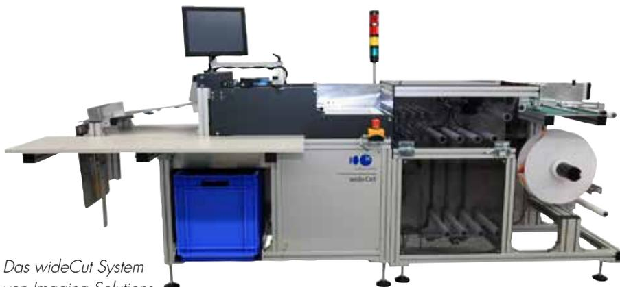
Das wideCut System von Imaging Solutions schneidet das Papier direkt von der Rolle automatisch in verschiedene Formate.
