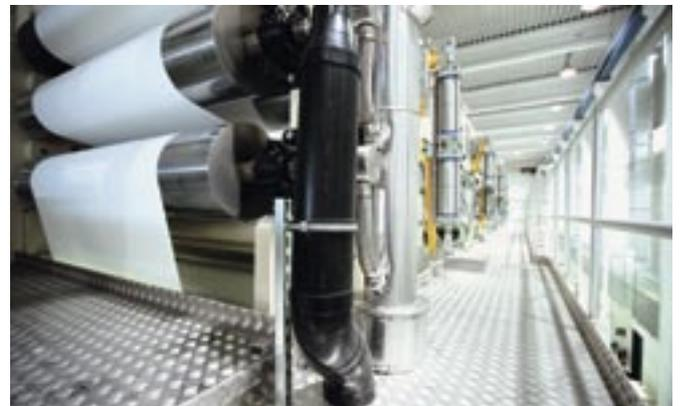
*In der Fabrik in Weißenborn produziert Felix Schoeller Medien für alle relevanten Imaging-Druckverfahren. Die Wertschöpfungskette reicht von der Papier-Reproduktion über das Beschichten mit Polyethylen sowie den jeweiligen Farbempfangsschichten bis zur maßgeschneiderten Konfektionierung und Versandlogistik.*
