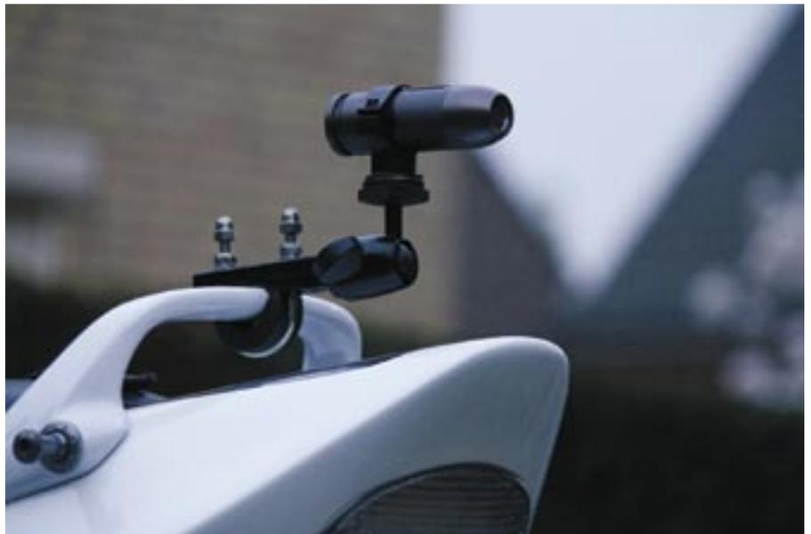
Die Rollei Bullet lässt sich unter anderem am Haltegriff eines Motorrads befestigen.
