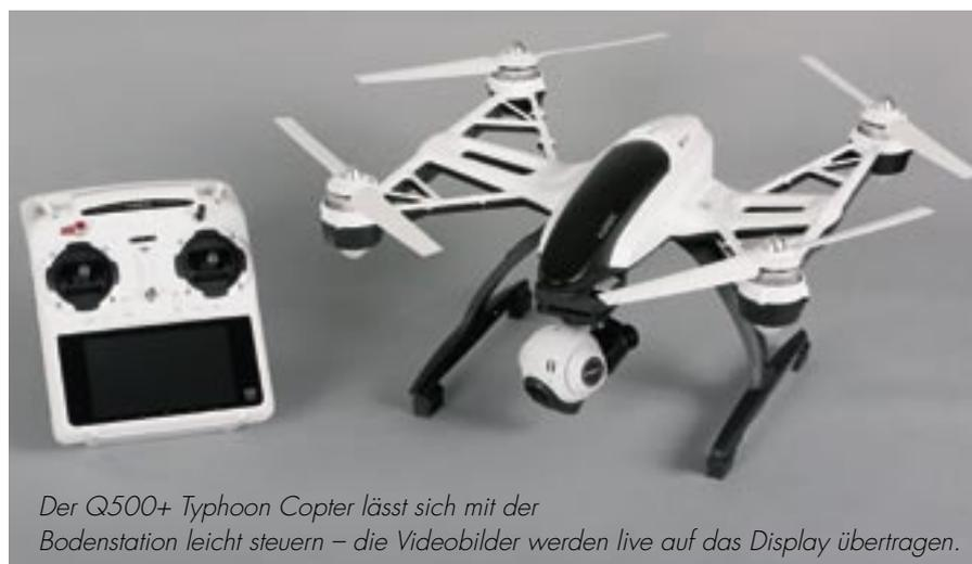
*Der Q500+ Typhoon Copter lässt sich mit der Bodenstation leicht steuern – die Videobilder werden live auf das Display übertragen.*
