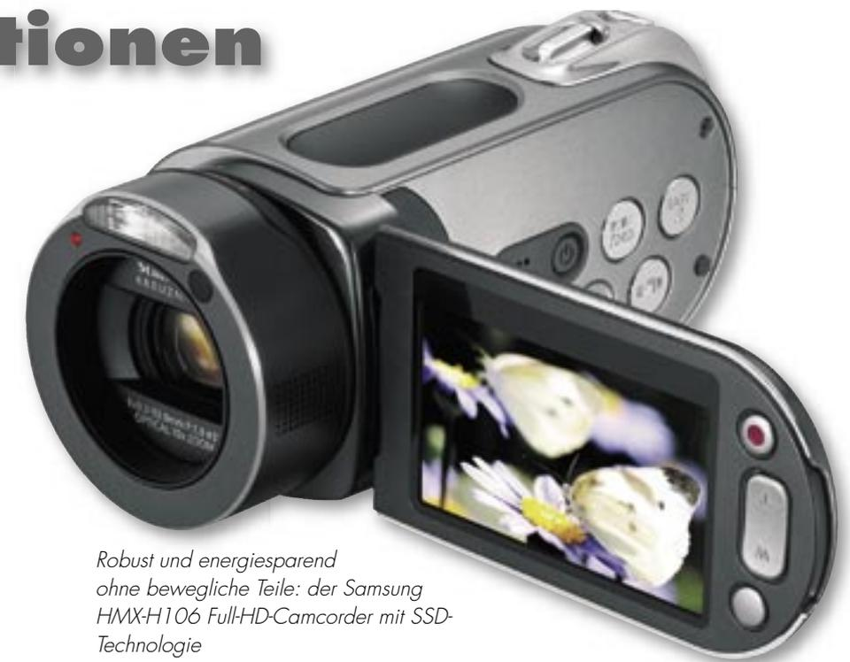
*Robust und energiesparend ohne bewegliche Teile: der Samsung HMX-H106 Full-HD-Camcorder mit SSD-Technologie*
