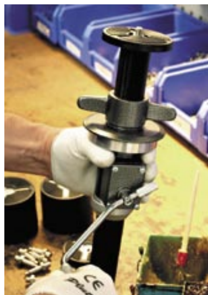
Trotz modernster Fertigungstechniken ist bei der Endmontage, wie beispielsweise den Gitzo Mittelsäulen (Bild oben), noch eine Menge Handarbeit erforderlich. Eine aufwendige Endkontrolle (Bild links) stellt die präzise Funktion der Gitzo Stative sicher.
