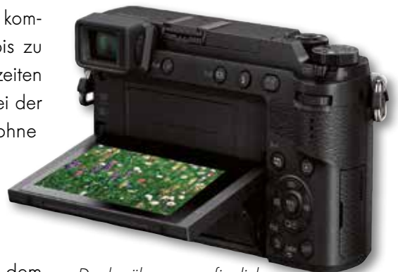
Der berührungsempfindliche, 7,5 cm großen LCD-Monitor kann um bis zu 80 Grad nach oben und 45 Grad nach unten geschwenkt werden.
