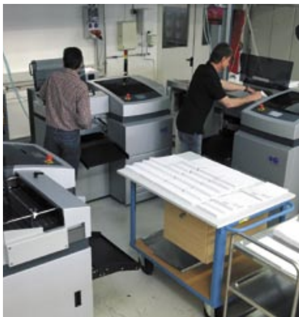
Mit dem fastBook-Gerät werden die Fotobuchseiten zum fertigen Buchblock mit spezieller lay-flat-Bindung verarbeitet – fertig zum dreiseitigen Beschnitt und Einhängen in das Cover.
