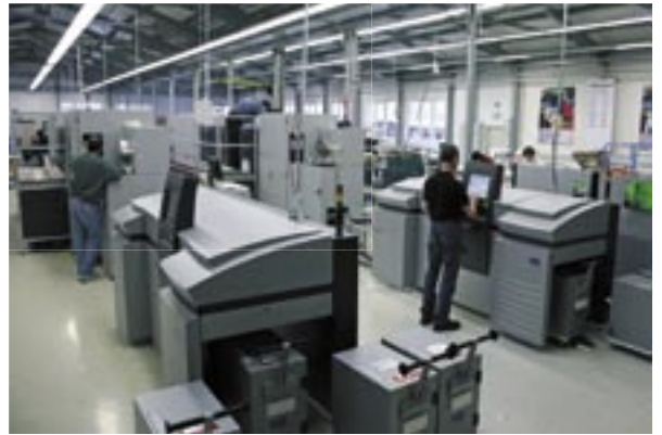
Herzstück der purePhoto Buchseiten: der widePrint Belichter mit angeschlossenem VSP-25 Papierprozessor von imaging solutions.
