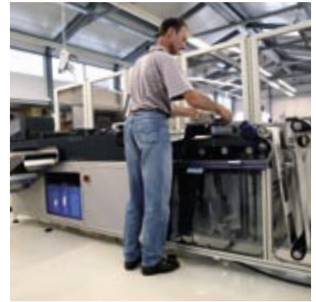
Die Weiterverarbeitung der belichteten Fotobuchseiten erfolgt zunächst mit dem fastCCF-Gerät.
