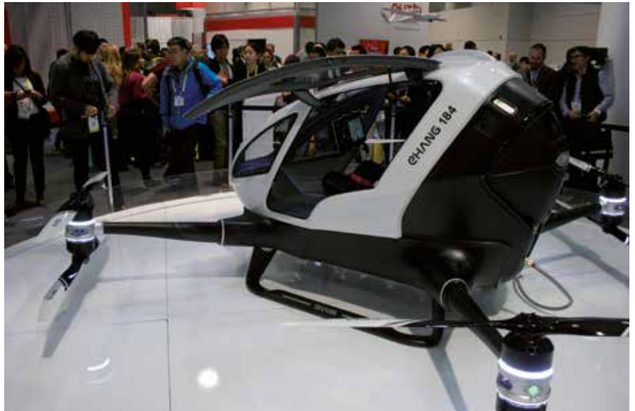
Der Kopter zum Mitfliegen: Das chinesische Unternehmen Ehang stellte eine „bemannte Drohne“ vor, die ihren Piloten automatisch ans Ziel bringt, das über eine App eingegeben wird. Rund 23 Minuten soll das von acht Motoren angetriebene Luftfahrzeug mit einer Batterieladung fliegen können. Der Pilot darf allerdings nicht mehr als 100 kg wiegen.
