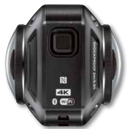
Die neue Action Kamera Nikon KeyMission 360 nimmt mit zwei Aufnahmemodulen 360 Grad Videos in 4K auf.
