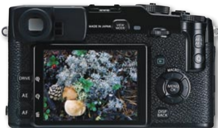
Ein Blick auf die Rückseite der X-Pro1 mit dem 3" großen, besonders leuchtstarken LCD-Monitor (1,23 Millionen Bildpunkte) bestätigt den hochwertigen Eindruck des Kameragehäuses.
