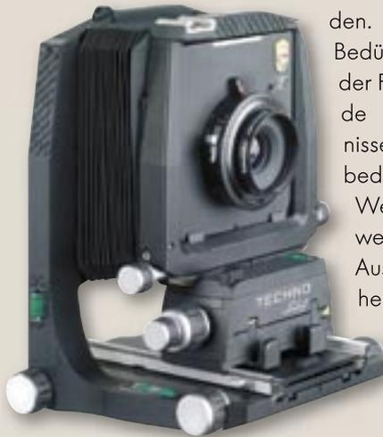
Die Fokussierung erfolgt über den Kameraauszug und nicht über einen Objektiv-Schneckengang. Das gestattet sehr große Auszüge bis 240 mm als Voraussetzung für langbrennweitige Objektive. Durch Drehen und Neigen des Objektivs lassen sich Schärfedehnung und feinste Schärfedifferenzierungen kreativ einsetzen. Alle Bedienelemente sind ergonomisch angeordnet und mit Linhof Präzision gefertigt. Skalen in Millimeter und Grad lassen genaue Kontrolle der Einstellungen zu.
