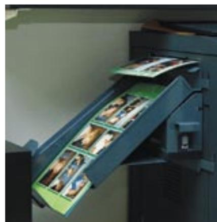
Wenige Minuten nach dem Druckbefehl erfolgt die Ausgabe der doppelseitig bedruckten Fotobuchseiten.
