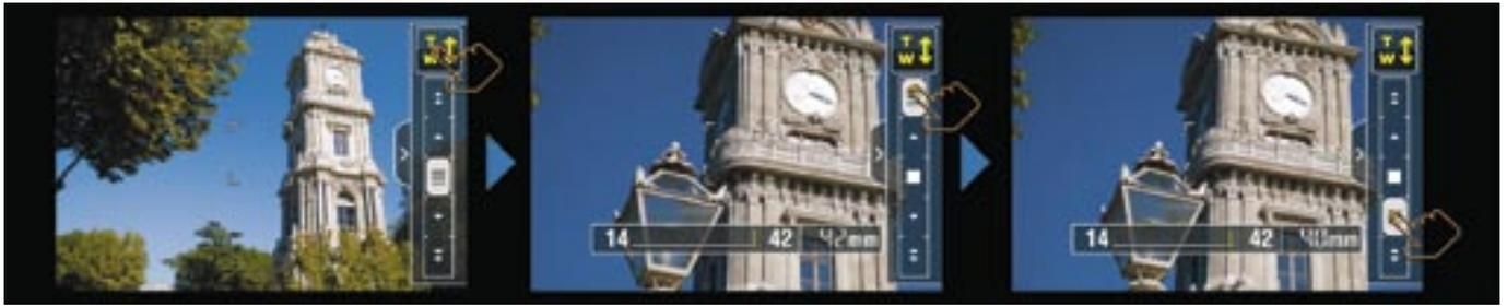
Ist das Lumix G X Vario PZ 14–42 mm F.3,5–5,6 ASPH. oder das Lumix G X Vario PZ 45–175 mm F4,0–5,6 ASPH. an der Lumix GX1 angebracht, lässt sich die Zoomfunktion auf zweierlei Weise auch über das Touchdisplay nutzen.
