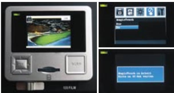
Bild links: Wenige Bedienelemente und ein leicht verständliches Menü erleichtern auch ungeübten Nutzern die Arbeit mit dem Rollei PDF-S 330 von Beginn an. Bilder rechts: Die Magic Touch Technologie verlängert beim Scannen zwar die Scanzeit, entfernt dafür aber automatisch Störungen durch Staub und Kratzer und spart so bei einer gegebenenfalls notwendigen Nachbearbeitung wieder Zeit ein.
