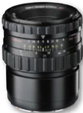
optische Aufbau in Form zweier symmetrisch angeordneter Linsengruppen gewährleistet konstante Abbildungsleistungen bei mittleren Aufnahmedistanzen bis nahe an 1:1. Jenseits von 1:1 wird das Objektiv in Retrostellung verwendet. Dank PQS-Zentralverschlussstechnik ist das Objektiv bis zu einer 1/1.000 Sekunde blitzsyn-
