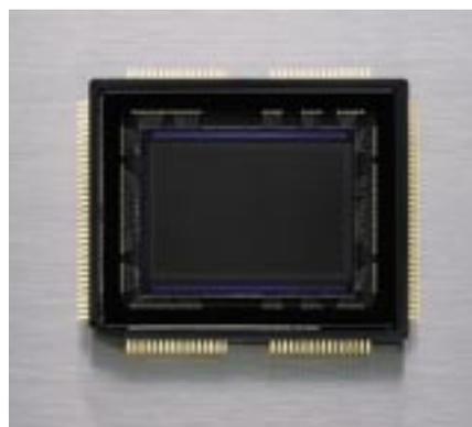
Der neue CMOS-Chip der D90 bietet effektiv 12,3 Megapixel.
