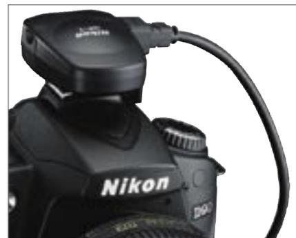
erfasst werden. Dazu speichert die Kamera Längen- und Breitengrad, Höhe des Aufnahmeorts und den Zeitpunkt der Aufnahme automatisch als Geotag zu jedem Bild in der Exif-Datei.
