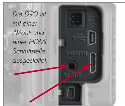
Die D90 ist mit einer AV-out- und einer HDMI-Schnittstelle ausgestattet.
