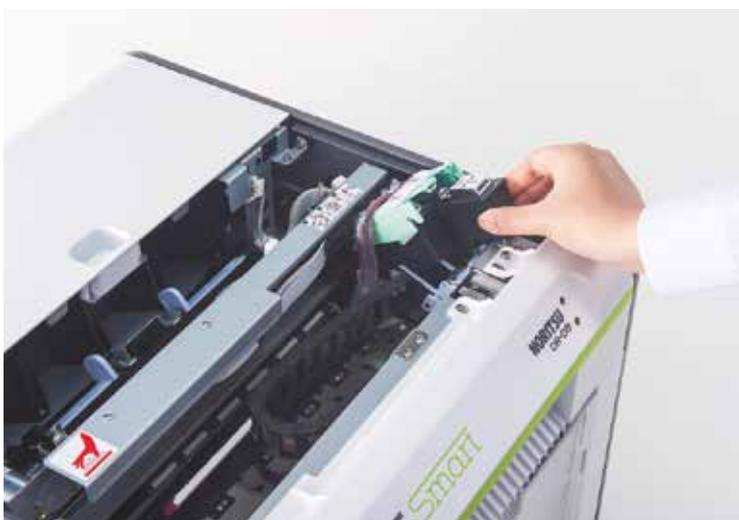
*Das von Noritsu mitentwickelte Inkjet-System arbeitet mit zwei Druckköpfen, die man bei Bedarf selbst wechseln kann.*
