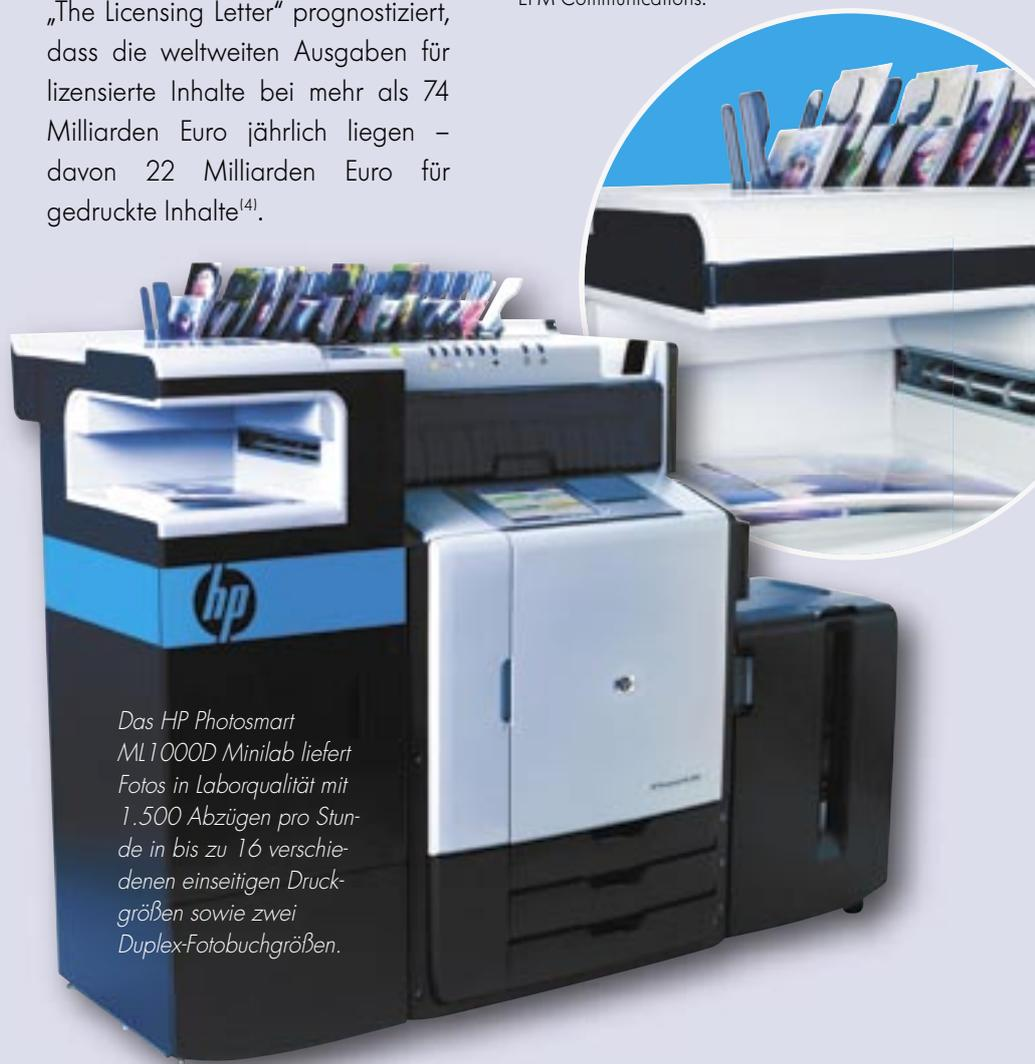
Das HP Photosmart ML1000D Minilab liefert Fotos in Laborqualität mit 1.500 Abzügen pro Stunde in bis zu 16 verschiedenen einseitigen Druckgrößen sowie zwei Duplex-Fotobuchgrößen.
