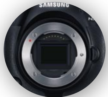
Der 28,2 MP BSI CMOS Sensor der Samsung NX1 wurde komplett neu entwickelt.
