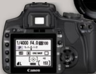
Auf dem 2,5“ großen LCD werden auch die wichtigsten Kamera-Funktionen angezeigt. Um Störungen beim Fotografieren zu vermeiden, schaltet sich das Display automatisch ab, sobald die Kamera ans Auge genommen wird.
