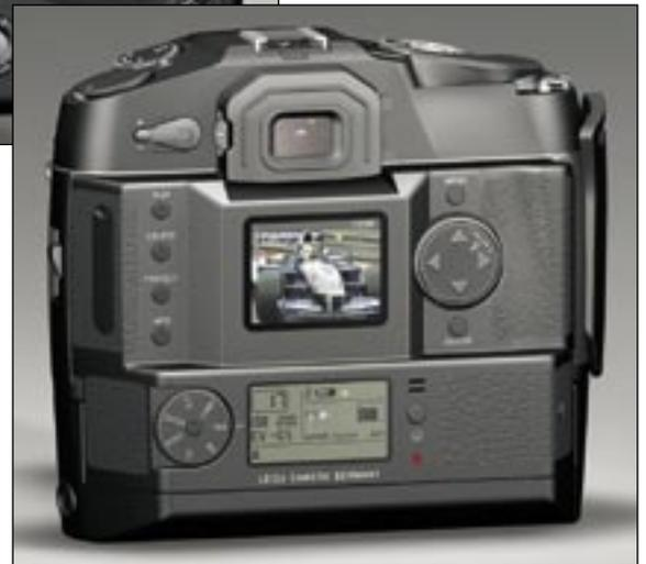
der Leica R8 oder R9 befinden muß. Deshalb ist die aktive Sensorfläche zwangsläufig kleiner als das Filmfenster. Der daraus resultierende Brennweitenverlängerungsfaktor konnte auf den Wert von 1,37x begrenzt werden. Nur ein kleiner Bildrand wird abgeschnitten.
