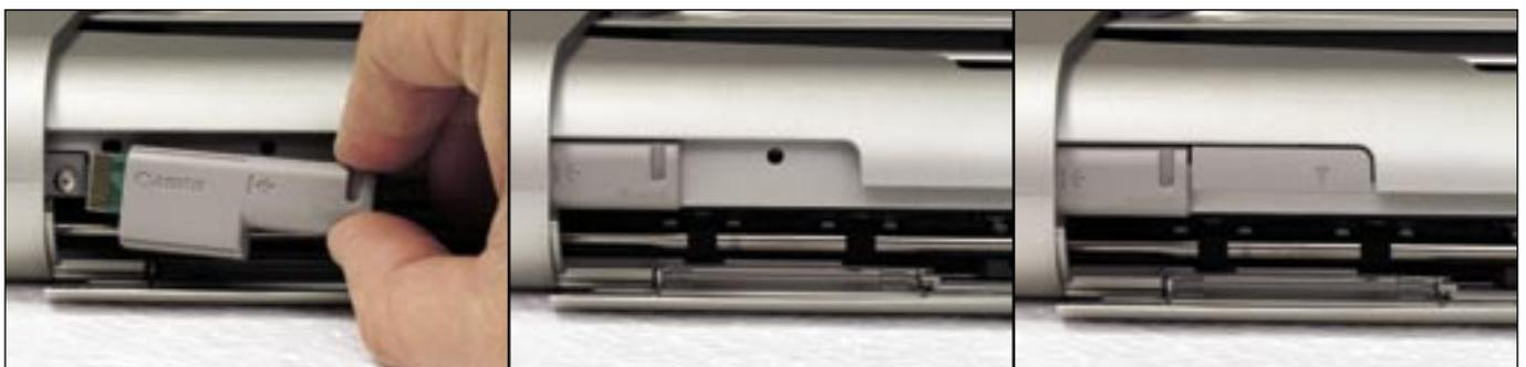
*Mit wenigen Handgriffen läßt sich die Funktionalität des Canon i80 mit einem Bluetooth-Adapter ausbauen.*
