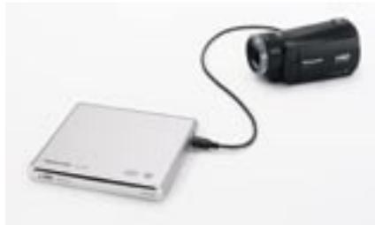
*Die USB Host Funktion des SD5 ermöglicht es, Videoaufnahmen per Knopfdruck über ein USB-Kabel auf den optional erhältlichen DVD-Brenner VW-BN1 zu übertragen.*
