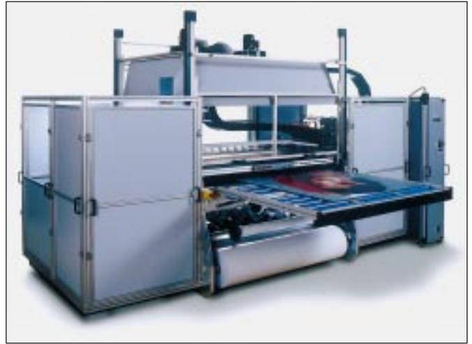
bereitungskosten geringer. Dadurch sind Einzelstücke und kleine Auflagen kostengünstiger zu produzieren. Die UV-härtende Pigmenttinte macht ein Laminieren des Materials nach dem Druck zum Schutz gegen Witterung überflüssig. Aufträge mit variablen Daten können laut Reger in kürzester Zeit verarbeitet werden.
