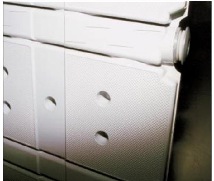
Die neu entwickelten Racks der Selexxa RP LV weisen eine spezielle Oberflächenstruktur auf, um die starke Agitation zu gewährleisten.
