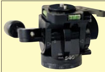
Mod. 540. Er bietet eine integrierte Schnellkupplung mit Verriegelungssicherung, einen vertikalen Schwenkbereich von 90° in beide Richtungen und Friktionseinstellung für Vertikalschwenks. Für Vertikalschwenks ist eine zuschaltbare Lastaufnahmefeder für Gewichte über zwei Kilogramm vorhanden. Mehrere Stablibellen ermöglichen die exakte Justierung. Der Panoramakopf ist mit Gewichten bis zu fünf Kilogramm
