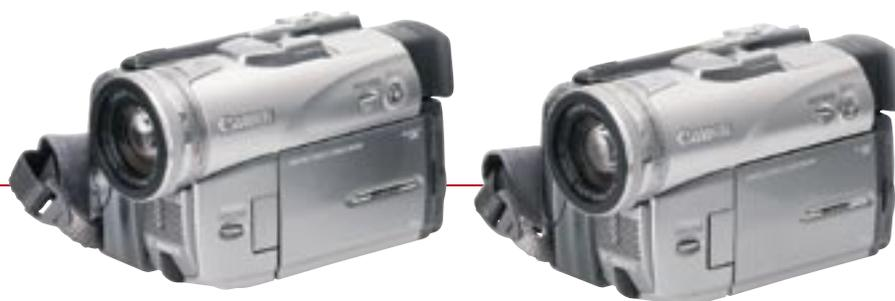
Dank des RGB-Primärfarbfilters vor dem CCD-Chip ist das Bildverarbeitungsprinzip das gleiche wie bei den Canon Digitalkameras. Für den guten Ton sorgt ein neuer Audioschaltkreis, der mit adaptiver Rauschunterdrückung störende Laufwerks- und Windgeräusche während der Aufnahme verringert. Beim MVX25i kann zudem der Audiopegel bei Anschluß
