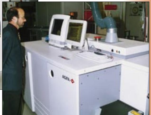
*Die d-ws Module d-gate, d-scan 20 und d-print 20 im eurocolor Labor in Gera. Der schwarze Papierkanal links vom d-print 20 führt direkt in die VSP 50 Papierentwicklungsmaschine.*
