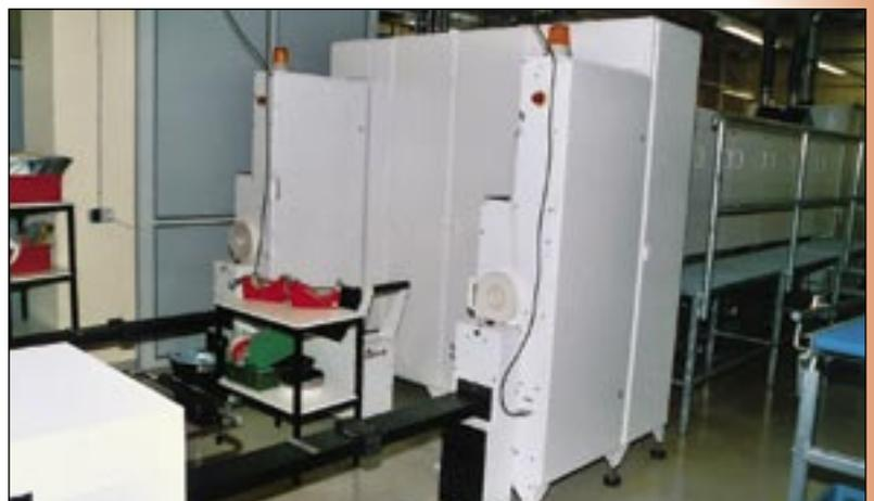
ber und die Fähigkeit, Batchgrößen bis zu 600 m Film zu verarbeiten, erhöhen die Produktivität des Gerätes, das sowohl 35 mm- als auch APS-Filme verarbeiten kann.
