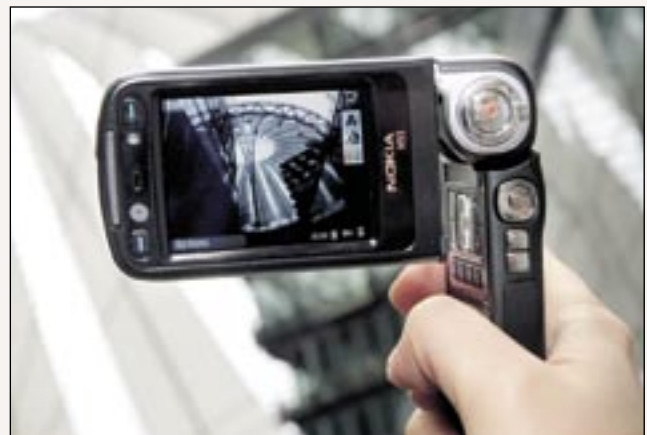
Bei Foto- und Videoaufnahmen dient das 2,4" große Display des Nokia N93 in voller Größe als Sucher.
