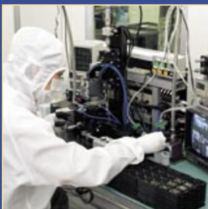
Die Produktion findet unter absoluten Reinraumbedingungen statt. Viele Schritte sind notwendig von der Überprüfung der einzelnen Komponenten mit mikroskopischer Staubkontrolle, der Funktionsprüfung der elektronischen Bauteile bis zur Endmontage und sorgfältigen Kontrolle des fertigen Produktes.
