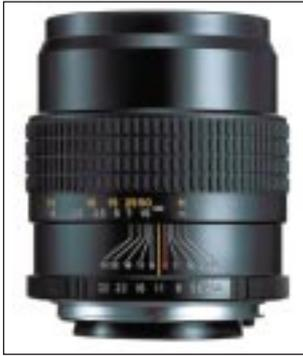
hat die Brennweite 100 mm und Lichtstärke 1:4,5. Die optische Konstruktion besteht aus sechs Linsenelementen in fünf Baugruppen. Die kürzeste Einstellentfernung beträgt 1,8 Meter. Das RF 4,5/100 mm ist 83,5 mm lang, hat einen größten Durchmesser von 76 mm und wiegt 450 Gramm. Mit ihm lassen sich Filter mit einem Durchmesser
