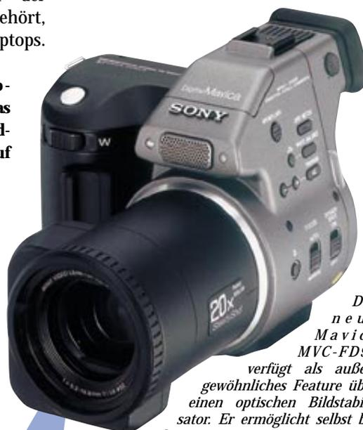
Die neue Mavica MVC-FD95 verfügt als außergewöhnliches Feature über einen optischen Bildstabilisator. Er ermöglicht selbst bei langen Brennweiten verwacklungsfreie Aufnahmen. Die Diskettenkamera Mavica erfreut sich wegen ihrer einfachen Handhabung besonders bei beruflichen Anwendern großer Beliebtheit.
