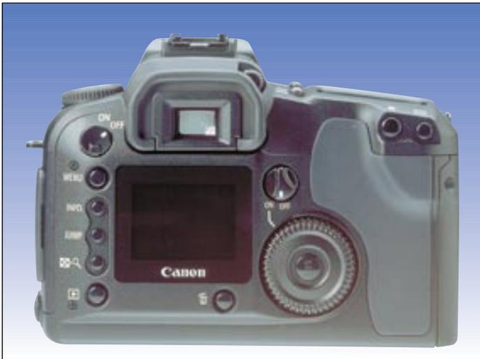
Viele digitale Funktionen der EOS D30 stehen dem Anwender über direkten Tastendruck zur Verfügung. Der neue SET-Button auf der Unterseite erleichtert den Zugriff auf die Menüfunktionen.
