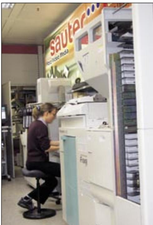
Die hausinterne Ausarbeitung der digitalen Bildaufträge erfolgt über ein Minilab Fujifilm Frontier 370.
