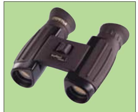
Gehäuse mit wasserdichter Versiegelung und zehnfache Vergrößerung. Das Sehfeld auf 1.000 m beträgt 105 m, und die Dämmerungszahl ist 16,1. Die Steiner Neuheit besitzt darüber hinaus ein Objektiv mit 26 mm Durchmesser und eine Austrittspupille von 2,6 mm. Es wiegt 270 Gramm. Seine Baulänge wird mit 114 mm angegeben.
