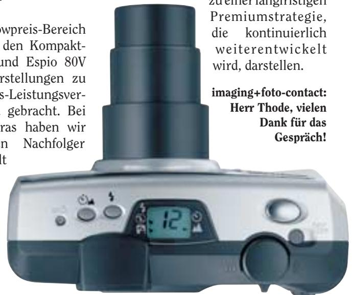
Einen vielseitig einsetzbaren Brennweitenbereich von 38 bis 115 mm bietet das neue Kompaktkameramodell Espio 115V.
