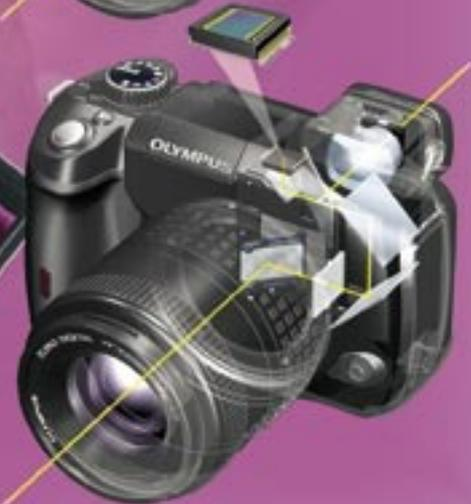
**Zwei separate Bildsensoren ermöglichen die kontinuierliche Bildanzeige im Display**
