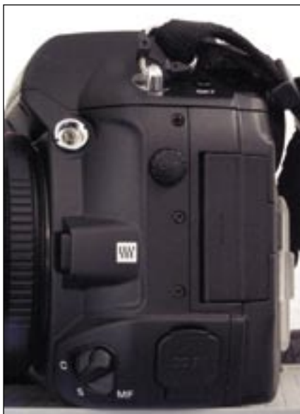
Im Vergleich zu früheren E-Modellen zeigt sich die Olympus E-1 vor allem an der linken Gehäuseseite deutlich aufgeräumter. Neu hinzugekommen ist die Möglichkeit, das Autofokussystem auch im Continuous-Mode einzusetzen.
