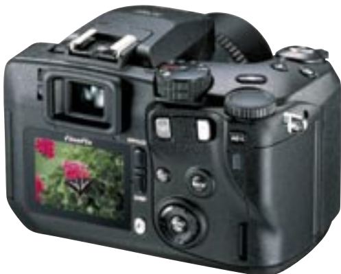
Die Rückseite der FinePix S20 Pro zeigt den 1,8 Zoll großen TFT, der eine Auflösung von 118.000 Pixeln bietet.
