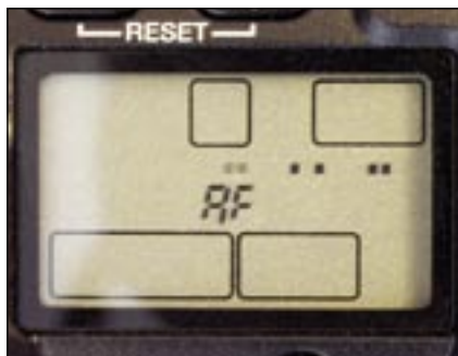
Neu bei der Olympus E-1 ist ein Knopf, mit dem der Benutzer den Autofokus-Meßbereich verändern kann.
