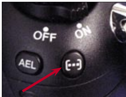
Neu bei der Olympus E-1 ist ein Knopf, mit dem der Benutzer den Autofokus-Meßbereich verändern kann.
