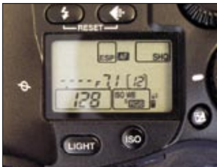
Die Lichtempfindlichkeit läßt sich bei der Olympus E-1 problemlos über einen Knopf an der Kameraoberseite einstellen.
