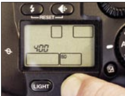
Die Lichtempfindlichkeit läßt sich bei der Olympus E-1 problemlos über einen Knopf an der Kameraoberseite einstellen.
