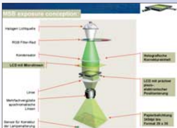
Die neue MSB-Belichtungseinheit ist das Herzstück des neuen digitalen Kis-Minilabs.
