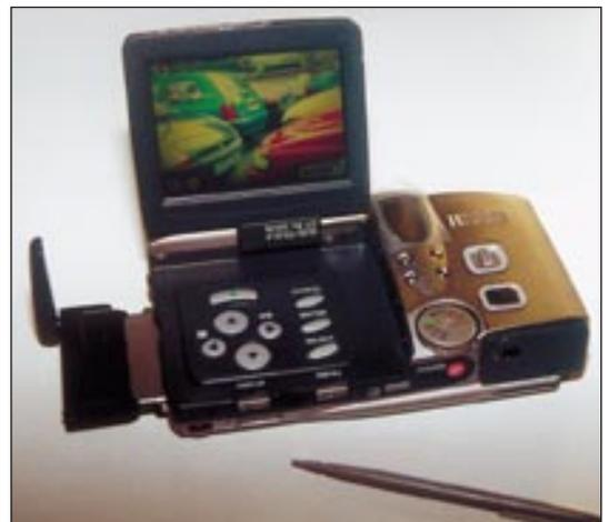
*Links im PC-Schacht der RDC-i700 steckt eine Mobiltelefonkarte von Nokia, die den Versand von Bilddaten ermöglicht. Händler, die auch Telekommunikationsprodukte im Sortiment haben, können sie als Zubehör zur Kamera verkaufen.*
