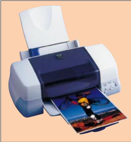
Auch der Epson Stylus Photo 870 bietet die Sechs-Farb-Drucktechnik, die mit noch kleineren Tropfen, neuen Druckertreibern und dem von Epson entwickelten Acu-Photo Halftoning-Verfahren (Halbtonverfahren) weiter optimiert wurde.
