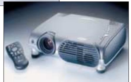
Der Monitorausgang ermöglicht die Betrachtung der Präsentation auf einem lokalen Bildschirm. Eine bedienerfreundliche und einfache Handhabung soll das auf Text basierende Menü gewährleisten. Alle Funktionen sind laut Hersteller intuitiv zu bedienen. Setup und Anpassung erfolgen automatisch. Kabel und Anschlüsse sind farbocodiert, angeschlossene Geräte werden automatisch erkannt. Abmessungen (270 x 210 x 70 mm bzw. 297 x 248 x 96 mm) und Gewicht (2,6 kg/3,6 kg) machen die Geräte flexibel.
