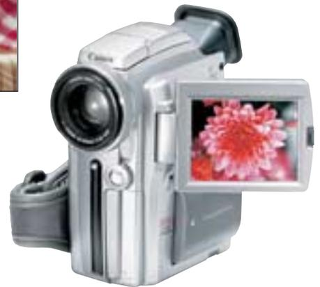
*Der MVX2i von Canon ermöglicht eine getrennte Verarbeitung von Standbild- und Videosignal und damit eine für beide Aufnahmeverfahren optimierte Bildqualität.*
