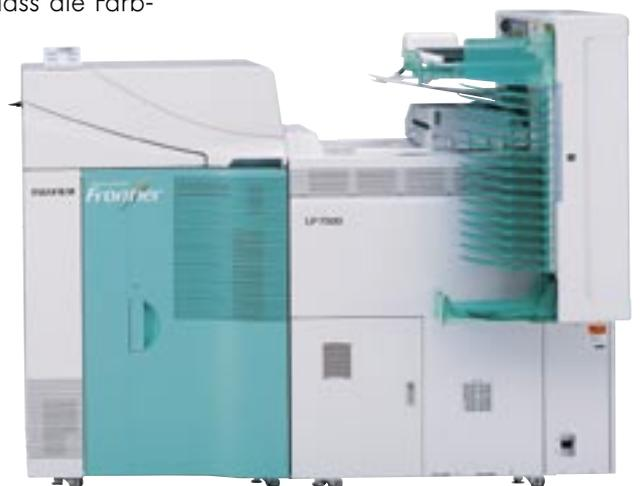
Ab dem Modell LP 7500 (Foto oben) gehört bei den neuen Frontier Minilabs ein maximales Bildformat von 30 x 90 cm zum Standard.
