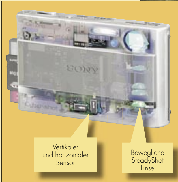
Der doppelte Bildstabilisator ermöglicht auch ohne Blitz verwacklungsfreie Aufnahmen bei natürlichen Lichtverhältnissen.
