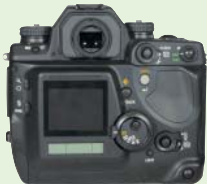
Der LCD-Monitor auf der Rückseite hat dreierlei Funktionen. Er dient der Motivkontrolle, der Information über Aufnahmedaten sowie der Darstellung der grafischen Benutzeroberfläche.
