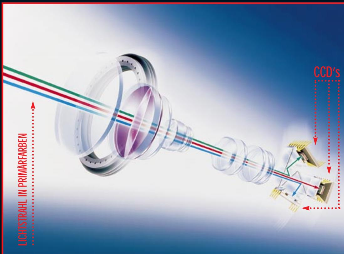
**Und das funktioniert folgendermaßen:** Je einer der drei Chips zeichnet eine der Primärfarben Rot, Grün und Blau auf. Hierfür wird das durch das Objektiv fallende Licht aufgespalten (siehe Abb.) und dem betreffenden Bildwandler zugeführt. Basierend auf einem 320.000 Pixel-Chip erreicht man mit Pixel-Shift die Wirkung eines Chips mit wesentlich mehr Pixel.
