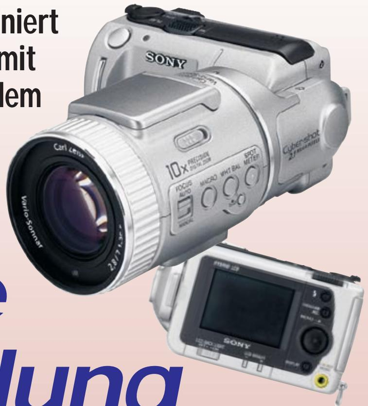
Auf den ersten Blick fällt dem Anwender die recht ungewöhnliche Bauart der DSC-F505 auf. Das um 140° vertikal schwenkbare Objektiv dominiert ganz klar das Erscheinungsbild der Kamera. Es verfügt über eine Brennweite, die 38 bis 190 mm im Kleinbildformat entspricht, bei einer maximalen Blendenöffnung von 2,8. Beim Scharfstellen von Motiven hat der Anwender die Auswahl zwischen automatischer und manueller Focussierung – eine Beson-
