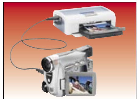
Per USB-Kabel können Fotos direkt vom Camcorder auf den Drucker übertragen und ausgegeben werden.
