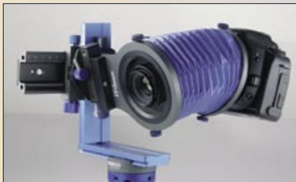
In der normalen Aufnahmestellung läßt sich auf diese Weise ideal nach Scheimpflug fotografieren. Wird das Balgengerät um 90° ins Hochformat gedreht, können stürzende Linien perfekt ausgeglichen werden.
