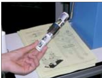
Eine Neuheit für Minilab-Besitzer: Mit der Honerkamp Filmroller-Packstation können Negative eingetascht und dann mit dem Indexbild zu einer handlichen Rolle kombiniert werden.
